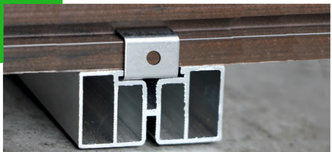
Полка для скрытого крепления кляймеров обеспечивает плотное и полное прилегание доски к поверхности лаги, что исключает деформацию поверхности настила.
